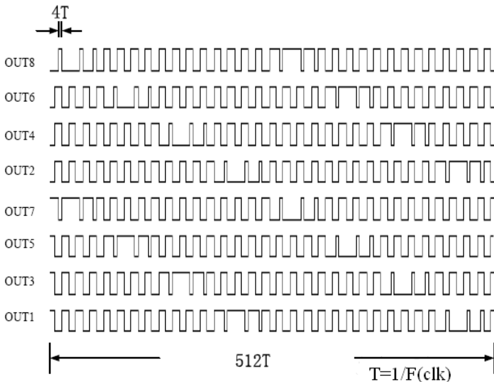
GC7500A 容栅传感器驱动波形图
