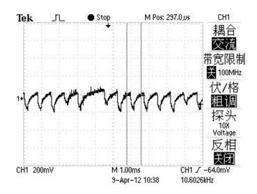
改善电源最常用的简单RC滤波能起到高频滤波的作用,如下图:
